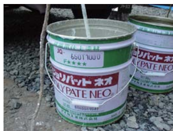
外壁吹付け ジョリパットネオ。
