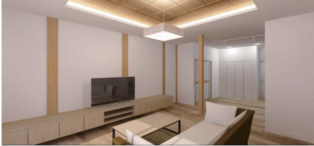
リビング。既存の木の格天井を保存し、周囲の間接照明で演出する。造作家具等も提案し、大断面の柱を生かして新しいデザインを取り込む。
