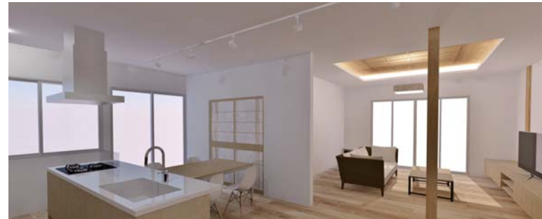
DKからリビング方向を見る。既存壁付のキッチンは対面式とし、東側に新たな開口部を設け朝日を取り込む。
